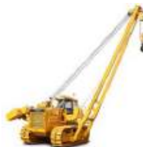
Трубоукладач ТЛ – ДТ
