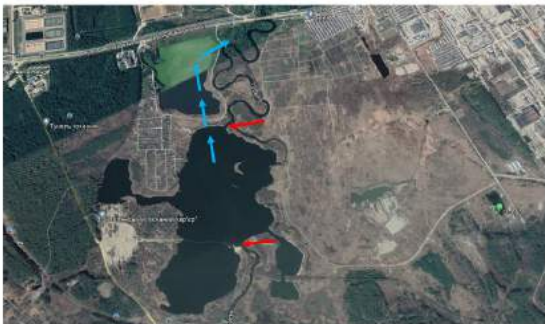
Рис. 8 Місця «впадання» та «витоку» річки Горинь із водойми піщаного кар'єру с. Поляна (зазначені червоними стрілками) та напрямки циркуляції води після формування з'єднувальних каналів №1 та №2 (зазначені синіми стрілками)
